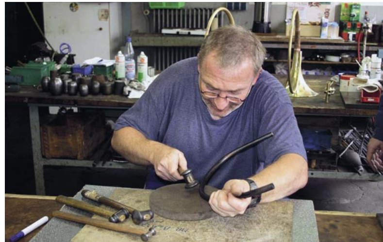
Mit dem Hammer klopft Werkstatteleiter Bernhard Goertz die Zwischenrohre, die sogenannten Anstöße, für ein Parforcehorn glatt.
