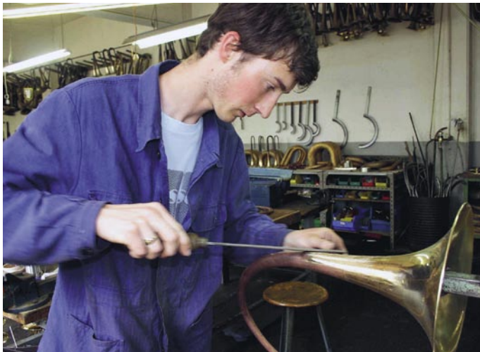
Lehrling Saxon Nautsch demonstriert das Feilen des Schallstücks, wodurch es eine glatte Oberfläche erhält.
